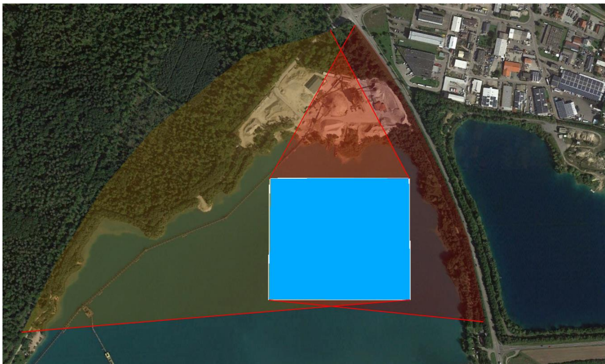
Abbildung 13: Modulfläche in blau; mögliche horizontale Reflexionswinkel für Ostausrichtung (rot) und Westausrichtung (gelb)
